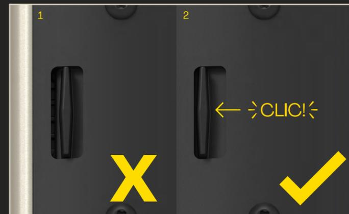
**i** THE STORAGE DOOR MUST BE PROPERLY ENGAGED TO ENSURE ITS ATTACHMENT AT THE DOWNTUBE LEVEL.
