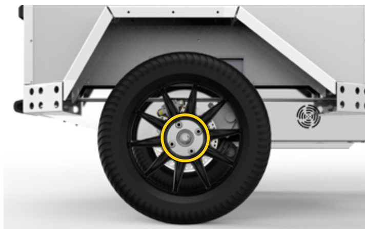
FIGURE 20 : EMBLACEMENT DES QUATRE VIS
