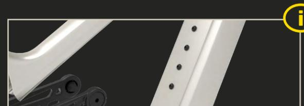
**i** LA POSITION INFÉRIEURE DES INSERTS EST RÉSERVÉE AU PORTE-BOUTEILLE TANDIS QUE LA POSITION SUPÉRIEURE EST EXCLUSIVE À L'EXTENSION DE BATTERIE BOSCH POWERMORE. LA BATTERIE POWERMORE N'EST PAS COMPATIBLE EN POSITION BASSE: CETTE POSITION ENDOMMAGERAIT L'AMORTISSEUR AINSI QUE LA POWERMORE. DEVINCI SE DÉGAGE DE TOUTE RESPONSABILITÉ QUANT À UNE MAUVAISE INSTALLATION QUI CAUSERAIT DES DOMMAGES À LA SUSPENSION ET À LA BATTERIE POWERMORE.
