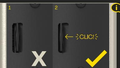
THE STORAGE DOOR MUST BE PROPERLY ENGAGED TO ENSURE ITS ATTACHMENT AT THE DOWNTUBE LEVEL.
